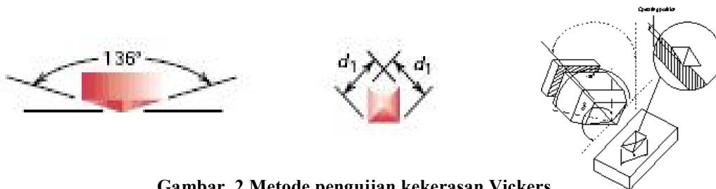
Gambar. 2 Metode pengujian kekerasan Vickers
